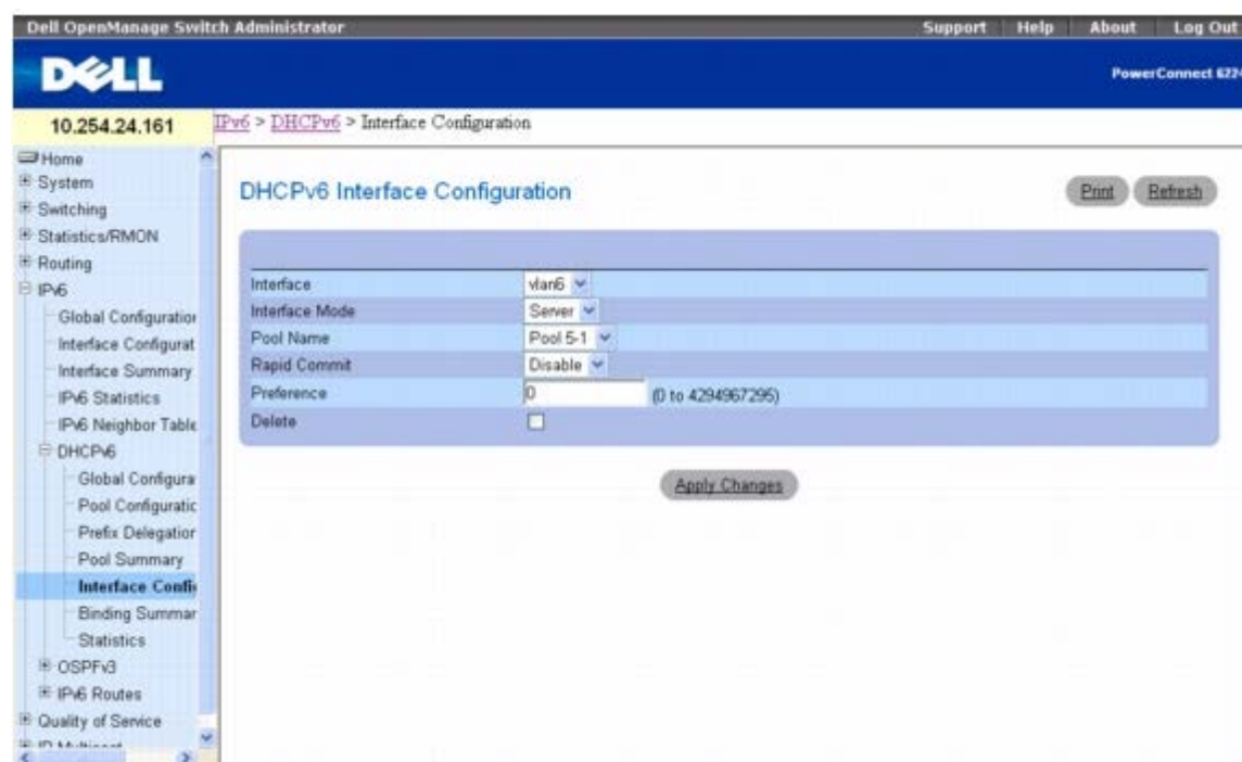
图 11-13. DHCPv6 接口配置 - 服务器
